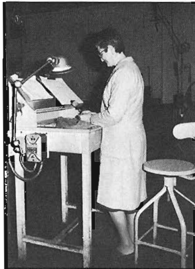
Contrôle du sertissage. On aperçoit les feuilles permettant d'effectuer le suivi statistique.
