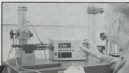
Etalonnage des cubes étalons par comparaison mécanique avec un comparateur différentiel Tesa modul.
